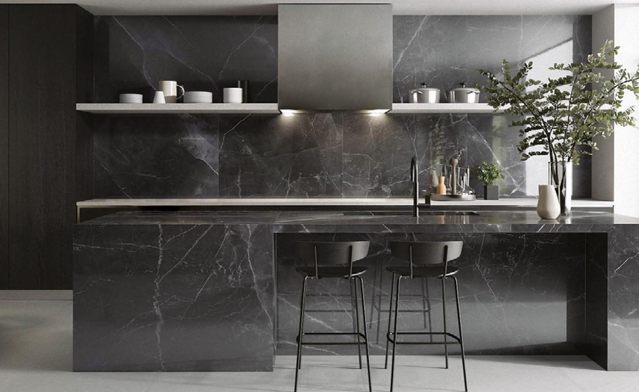
IT Oltre che nel suo sistema a induzione sottolastra, la rivoluzione di **CooKingRAK** risiede anche nelle grandi dimensioni delle lastre in grès porcellanato da cui è ricavato il suo piano cucina. Con un formato di 135 x 305 cm e uno spessore di 14,5 mm, le lastre **INGRES** permettono di realizzare piani dalla superficie incredibilmente ampia e continua.
